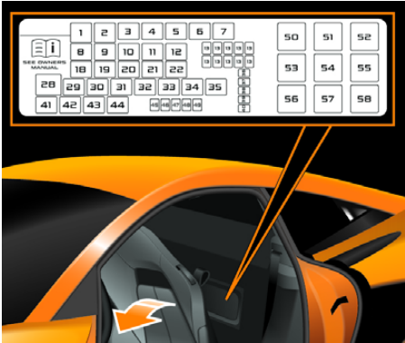
Gráfico de especificações de fusíveis da caixa de fusíveis principal
