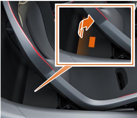
此识别码还刻在右侧座椅后面的底板上，并印在右侧车门孔底部的铭牌上，且可在驾驶员显示屏上的“系统”部分查看，请参见VIN，页码4.17。
