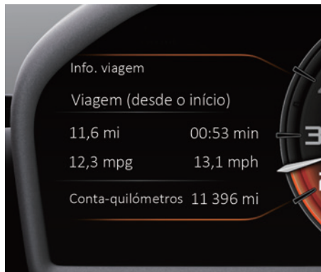
Ecrã retrátil do condutor - lado esquerdo
