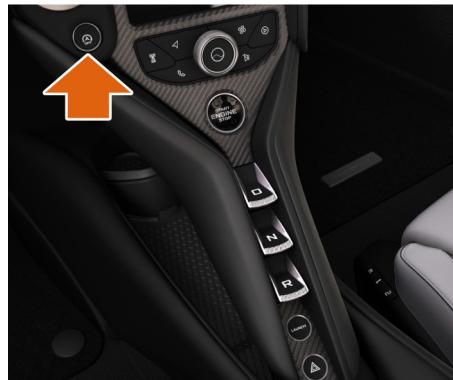
Appuyez sur le bouton d'arrêt du système Eco Start-Stop pour désactiver le système. Le témoin lumineux du bouton s'allume et le témoin d'état de l'Écran du conducteur s'éteint.
