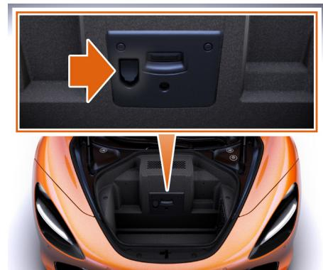
Reportez-vous aux instructions fournies avec le chargeur de batterie. Le chargeur doit être branché sur la prise pour accessoires du compartiment à bagages.
