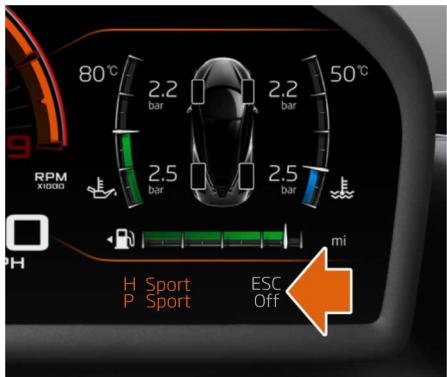
Affiche la confirmation du mode de contrôle électronique de stabilité (ESC) sélectionné.
