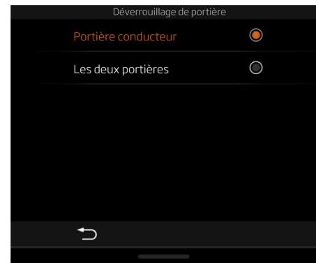
Lorsque Portière conducteur est sélectionné, seule la portière du conducteur se déverrouille lorsque le véhicule est déverrouillé à l'aide de la télécommande de clé ou du bouton de portière.
