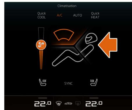
Le réglage de la distribution de l'air s'effectue à l'aide des commandes de distribution de l'air.
