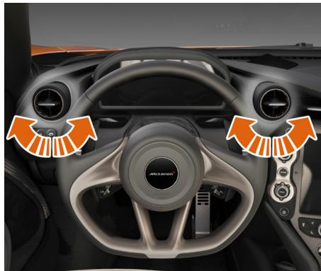
Faites tourner la molette d'un quart de tour dans l'une ou l'autre des directions pour ouvrir ou fermer la bouche d'air.
