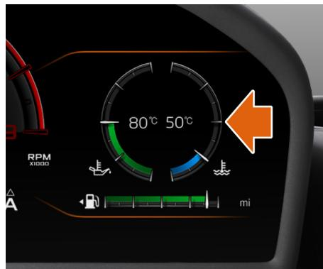
La température de l'eau s'affiche sous forme de jauge colorée sur le côté droit de l'Écran du conducteur.
