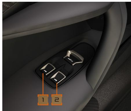
Poussez les commandes (1) et (2) vers le bas jusqu'à ce que les vitres s'ouvrent et maintenez-les dans cette position 5 secondes.
