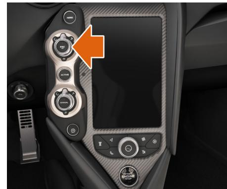
2. Faites tourner le bouton de contrôle du comportement routier pour sélectionner les modes suivants.
