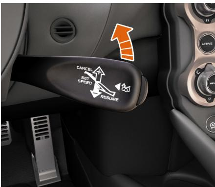
Avant de pouvoir activer le levage de la partie avant, il faut mettre le moteur en marche. Pour lever la partie avant du véhicule, activez le menu de levage de la partie avant (reportez-vous à Opération de levage de la partie avant, page 1.44) puis déplacez le commodo vers le haut.
