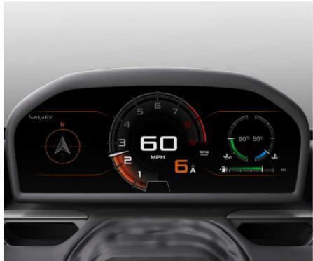
La fenêtre d'affichage fournit au conducteur un accès visuel aux réglages des commandes et aux valeurs de performance actuelles du véhicule. L'Écran du conducteur, illustré ci-dessus, s'affiche lorsque le véhicule est en mode Non actif/Confort.
