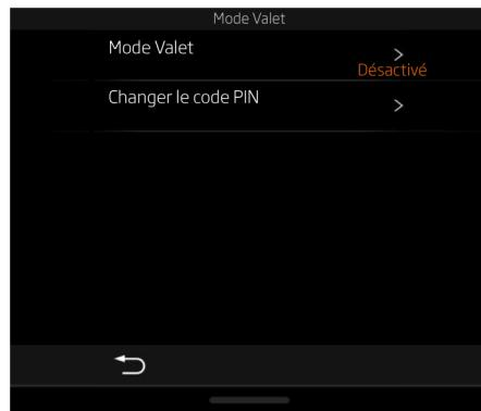
Lorsque le mode valet est activé, la vitesse du véhicule est limitée à 35 mph (55 km/h), le Panneau de dynamique active est désactivé, le compartiment à bagages, le compartiment de rangement de la console centrale et le capot moteur restent verrouillés, et un message de confirmation s'affiche sur le groupe d'instruments.
