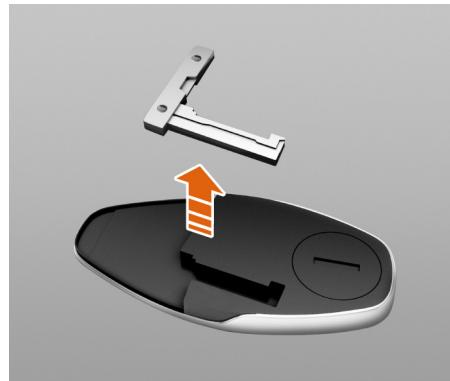
2. Dégagez et retirez la clé mécanique de la télécommande de clé.
