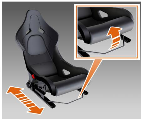
**REMARQUE :** il est possible de régler la position du siège uniquement vers l'avant et vers l'arrière.
