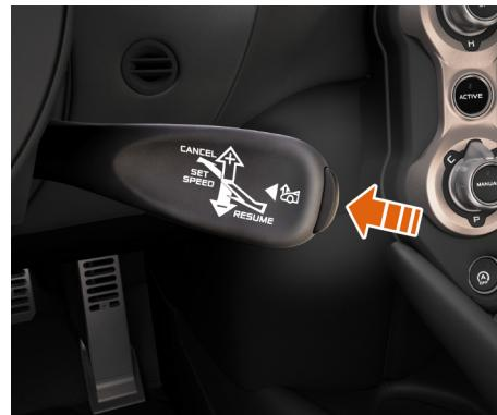
Pour activer le levage de la partie avant, il faut enfoncez le bouton du commodo situé à droite de la colonne de direction, à condition que le moteur soit en marche et que les portières soient fermées.
