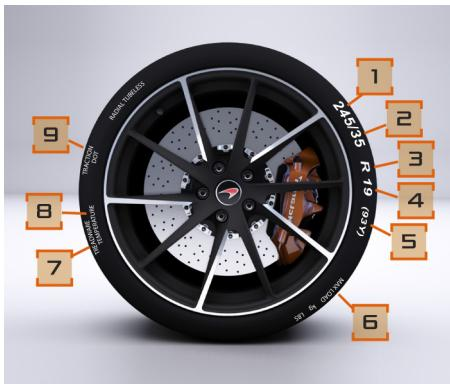
1. Largeur du pneu en millimètres.
