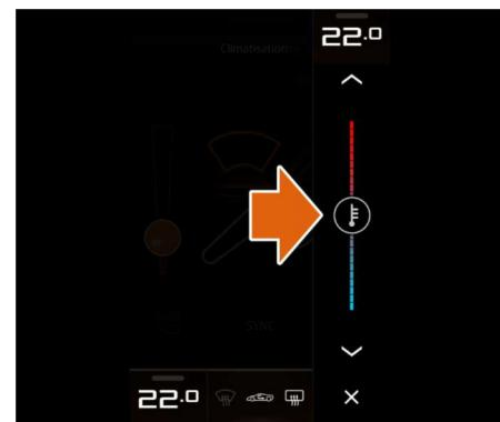
Appuyez sur le bouton pour augmenter la température ou sur le bouton pour la faire baisser. Vous pouvez également toucher le curseur de contrôle de la température et le faire glisser jusqu'au paramètre souhaité. Pour fermer le curseur de contrôle de la température, touchez le bouton .
