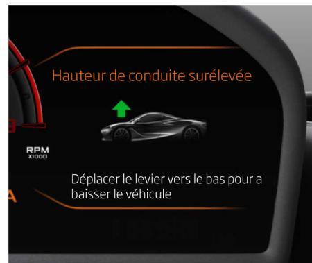
**i** Le changement de hauteur de conduite de la partie avant est confirmé par un signal sonore décroissant. Le message « Ablissement du véhicule » apparaît sur l'Écran du conducteur et l'icône de levage de la partie avant clignote.
