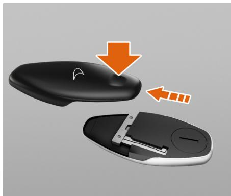
1. Appuyez sur le renforcement avec le pouce et faites coulisser le couvercle de la télécommande de clé pour l'ouvrir.
