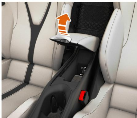
Des ports USB et une prise d'entrée audio auxiliaire de 3,5 mm se situent dans le compartiment de rangement. Reportez-vous à la section Connexion d'un périphérique externe, page 4.33.
