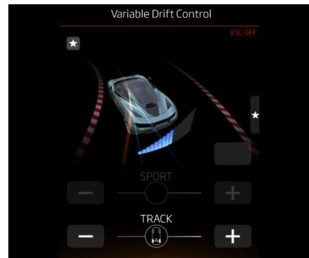
La quantité de dérive permise par l'ESC (contrôle électronique de stabilité) en modes Sport et Piste dynamique est réglable.
