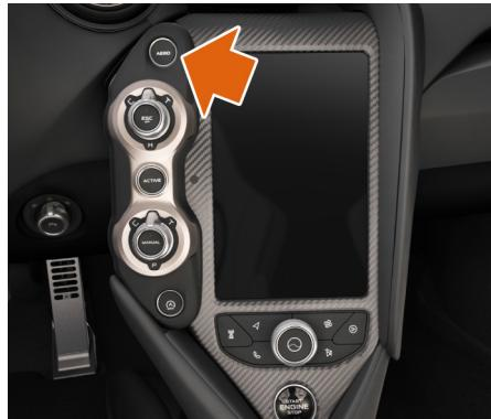
2. Appuyez sur le bouton AERO. L'aéofrein se relève et se bloque en position d'appui aérodynamique.
