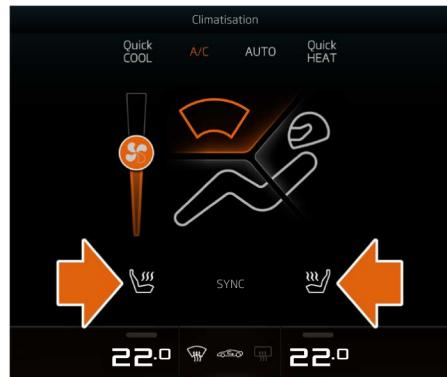
Touchez le bouton une fois pour activer le chauffage du siège au réglage de basse température ; une barre s'allume sur le bouton. Touchez à nouveau le bouton pour passer au réglage de température intermédiaire ; deux barres s'allument sur le bouton. Touchez à nouveau le bouton pour passer au réglage de température plus élevé ; trois barres s'allument sur le bouton.
