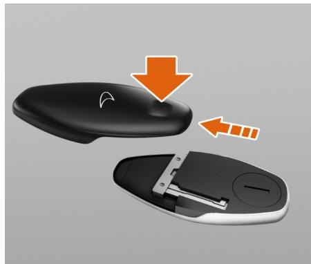
1. Appuyez sur le renflement avec le pouce et faites coulisser le couvercle de la télécommande de clé pour l'ouvrir.
