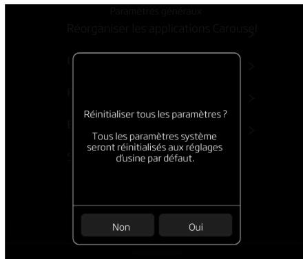
Selectionnez Oui pour réinitialiser tous les paramètres du véhicule et du MIS et rétablir les paramètres d'usine.
