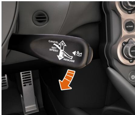
Pour abaisser la partie avant du véhicule, sélectionnez le menu de levage de la partie avant (reportez-vous à Opération de levage de la partie avant, page 1.44) puis déplacez le commodo de menu vers le bas.
