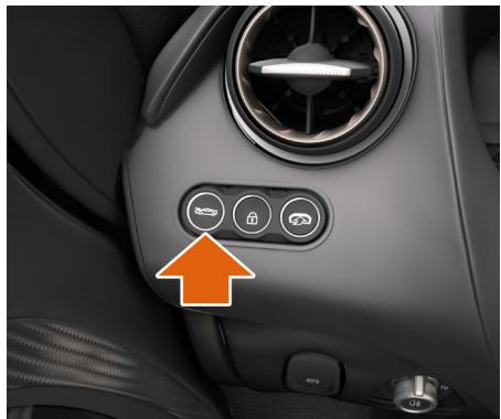
Vous pouvez également appuyer sur le bouton du tableau de bord pour déverrouiller complètement et ouvrir légèrement le compartiment à bagages.
