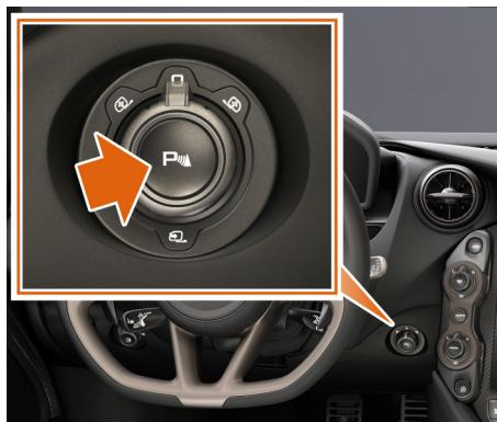
L'Assistance au stationnement 360 permet d'afficher une vidéo en direct sur l'Écran central montrant une vue à 360 degrés autour du véhicule.
