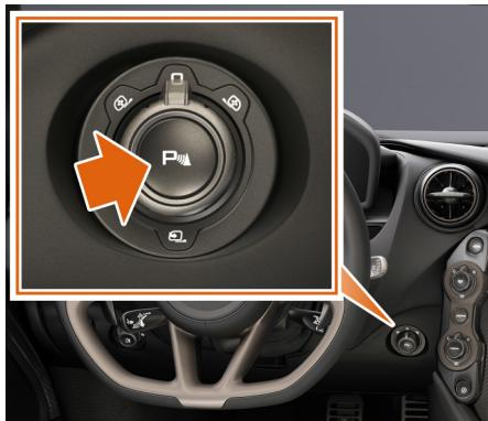
Les détecteurs d'obstacles avertissent le conducteur de chaque obstacle au cours d'une manœuvre à basse vitesse. Ce système est composé de quatre capteurs à ultrasons situés sur le pare-chocs avant, de quatre capteurs à ultrasons situés sur le pare-chocs arrière et de deux bippeurs. Chaque bippeur a un signal différent pour indiquer que l'obstacle est à l'avant ou à l'arrière du véhicule.
