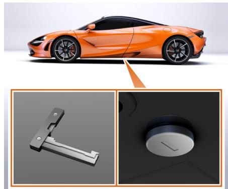
3. Insérez la clé mécanique dans le verrou et faites-la tourner dans le sens inverse des aiguilles d'une montre jusqu'à ce que la résistance mécanique empêche une plus grande ouverture de la portière.
