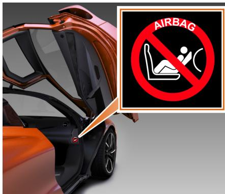
**AVERTISSEMENT :** si le témoin d'avertissement AIRBAG PASSAGER DÉSACTIVÉ n'est pas allumé, n'installez pas de dispositif de retenue pour enfants dos à la route sur le siège passager. Vous pouvez utiliser un dispositif de retenue pour enfants face à la route sur le siège passager. L'étiquette d'avertissement apposée sur le côté passager est là pour vous le rappeler.
