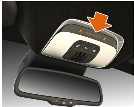
L'état des airbags est indiqué par le témoin d'avertissement PASSENGER AIR BAG OFF (airbag passager désactivé) de la console de plafond.
