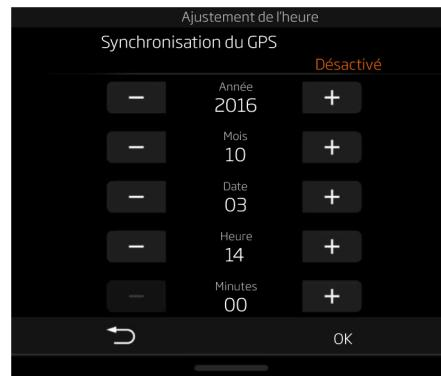
Sélectionnez **Synchronisation du GPS** pour régler automatiquement l'heure en utilisant le signal GPS. Activé est mis en surbrillance quand **Synchronisation du GPS** est activé.
