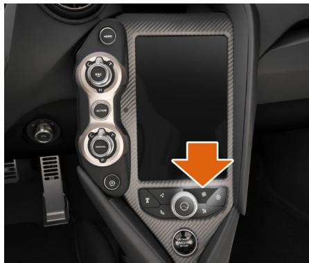
La climatisation fonctionne à l'aide de l'Écran central. Appuyez sur le bouton pour activer l'écran de commande du système de climatisation.
