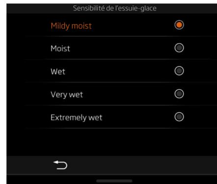
Selectionnez le niveau de sensibilité en fonction du réglage d'essuie-glace souhaité. Ce paramètre s'applique uniquement au niveau de sensibilité du détecteur de pluie et n'a aucun effet sur la fréquence d'intermittence de l'essuie-glace.
