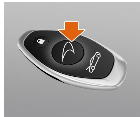
Pour déverrouiller le véhicule à l'aide de la télécommande de clé, appuyez sur le bouton de déverrouillage. Les clignotants avant, arrière et latéraux (selon le marché) clignotent deux fois et le système d'alarme antivol est désactivé.
