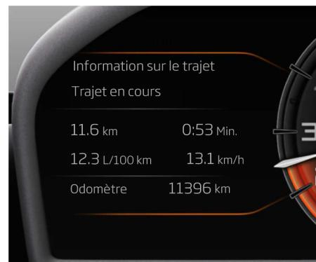
L'Écran du conducteur fournit des informations importantes pour le conducteur. Il varie en fonction du mode et des paramètres sélectionnés sur le véhicule.
