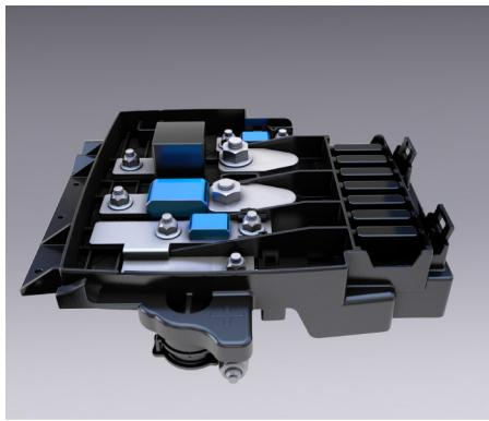
6. Retirez le fusible approprié et remplacez-le par un fusible présentant les mêmes caractéristiques que celui d'origine. En cas de doute, reportez-vous à Tableau de caractéristiques des fusibles du boîtier à fusibles de la batterie, page 6.22.
