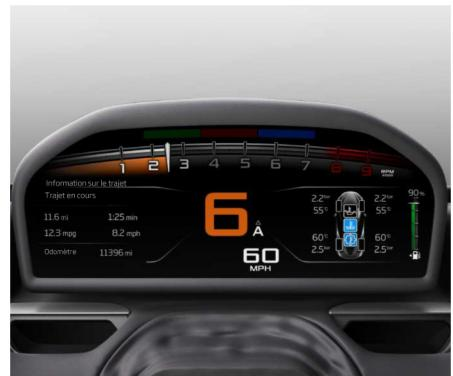
La fenêtre d'affichage fournit au conducteur un accès visuel aux réglages des commandes et aux valeurs de performance actuelles du véhicule. L'Écran du conducteur, illustré ci-dessus, s'affiche lorsque le véhicule est en mode Piste.
