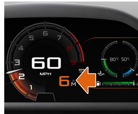
En mode manuel et avec une conduite plus économique, l'indicateur de changement de rapport (CSI) s'allume lorsqu'un passage à la vitesse supérieure permettrait de maintenir les performances optimales. Le GSI ne s'allume pas si l'accélération ou la décélération requise ne peut pas être atteinte avec une vitesse supérieure. Reportez-vous à la section Conduite économique, page 2.12.
