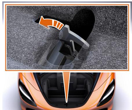
8. Soulevez le capot du compartiment à bagages et relâchez le verrouillage de sécurité.
