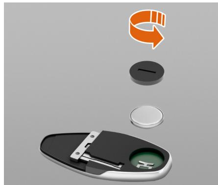
2. Dévissez le couvercle de la pile et retirez la pile déchargée.
