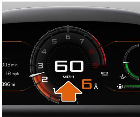
Le compteur de vitesse s'affiche au centre de l'Écran du conducteur quand le véhicule est en modes de transmission et de comportement routier Non actif ou Confort.
