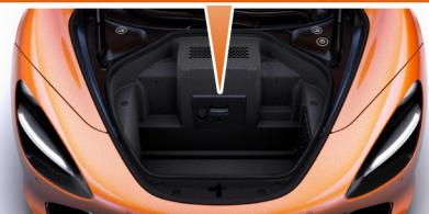
La prise pour accessoires, située dans le compartiment à bagages, a une limite de charge nominale de 20 A. C'est la seule prise pouvant être utilisée pour connecter le chargeur de batterie fourni par McLaren.
