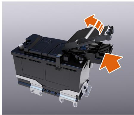
5. Appuyez sur les 2 verrous situés du côté droit du couvercle, puis retirez le couvercle du boîtier à fusibles.
