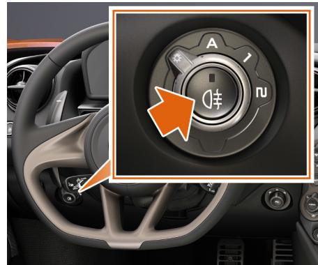
Appuyez sur le bouton du feu antibrouillard arrière situé au centre du contacteur d'éclairage.
