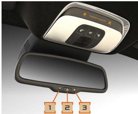
La fonction de gradation automatique du rétroviseur intérieur s'active et se désactive en appuyant sur la commande (2) en partie basse du rétroviseur. Le témoin (1) s'allume lorsque la gradation automatique est active.
