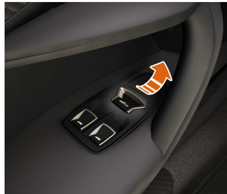
Relevez la poignée de la portière vers le haut, dans le sens de la flèche, et poussez la portière vers l'extérieur jusqu'à ce que le mécanisme
