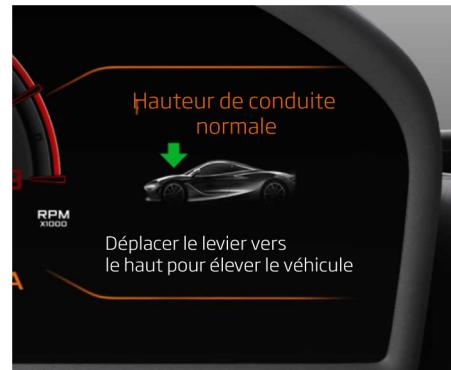
Le changement de la hauteur de conduite de la partie avant est confirmé par un signal sonore croissant. Le message « Levage du véhicule » apparaît sur l'Ecran du conducteur et l'icône de levage de la partie avant clignote.
