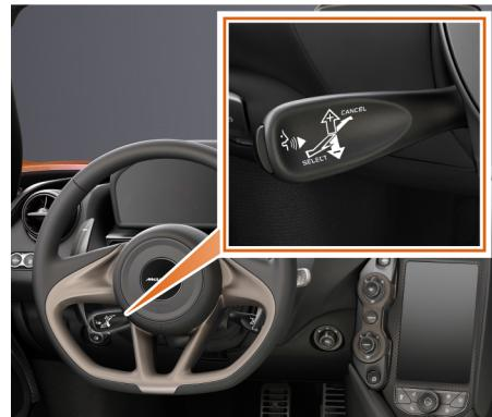
La navigation dans l'arborescence des menus se fait via le commodo situé à gauche de la colonne de direction.
