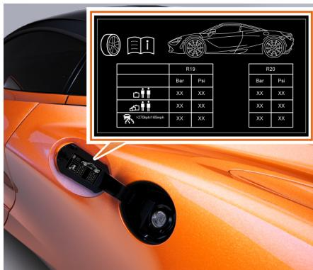
Pour connaître les différentes pressions des pneus en fonction des conditions d'utilisation, reportez-vous à la section Pression des pneus, page 7.8. Ces conditions sont également imprimées sur l'étiquette apposée au niveau de la trappe à carburant.
