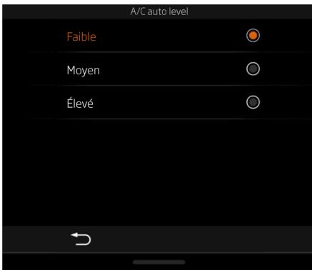
Le niveau automatique de climatisation sélectionné affecte la vitesse du ventilateur utilisé par le système de climatisation en mode AUTO.
