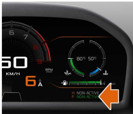
Lorsque le véhicule fonctionne indépendamment du mode de transmission et que les changements de rapport automatiques sont sélectionnés, la transmission adopte une stratégie de changement de vitesse économique pendant les phases de conduite non agressive. Les facteurs permettant d'identifier de telles phases sont la vitesse du véhicule, l'accélération, le freinage et l'inclinaison de la route.
