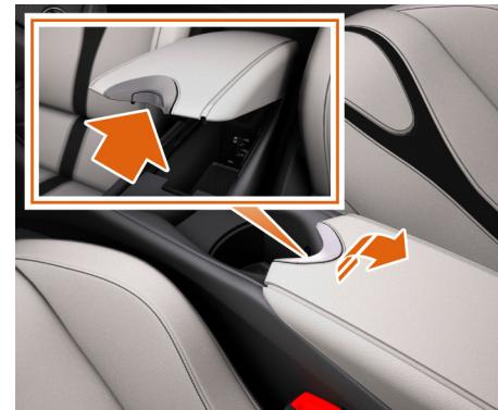
Un compartiment de rangement permettant de ranger de petits objets est installé dans la console centrale.
