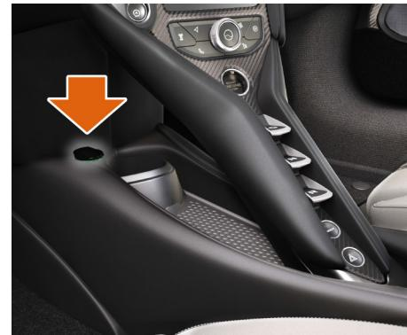
La prise intérieure 12 V pour accessoires se situe à côté du porte-gobelet de la console centrale et a une charge nominale maximale de 15 A.
