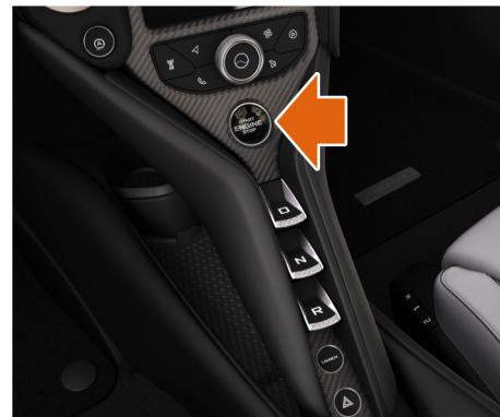
3. Appuyez sur le bouton START/STOP (démarrage/arrêt). Le moteur s'arrête et le véhicule passe à l'état Actif. Reportez-vous à État électrique du véhicule, page 2.2. L'antidémarrage est activé.
