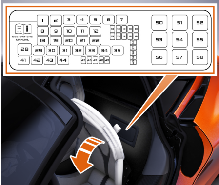
Cuadro de especificaciones de fusibles de la caja de fusibles principal
