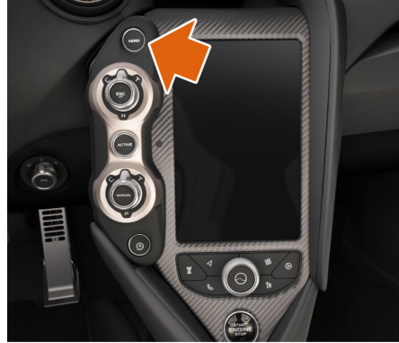
2. اضغط على الزر AERO (هوائي) وستعمل الفرامل الهوائية.
