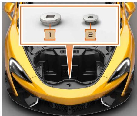
ホイールナットセンターロッキングリングの取り外し (2) およびナットトルク (1) 工具は、フロントラゲッジコンパートメントにあります。
