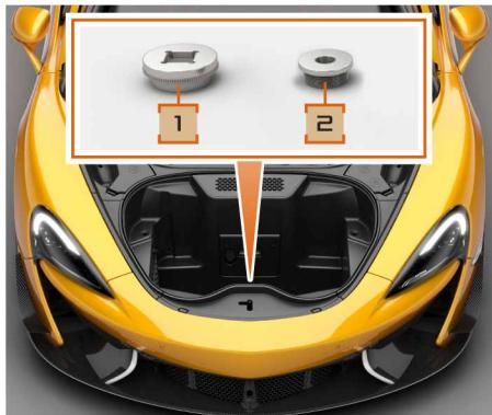
Les outils de dépose de bague centrale de blocage de l'écrou de roue (2) et de couple de serrage de l'écrou (1) se trouvent dans le compartiment à bagages avant.
