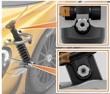
Le dispositif de réglage de détente est situé à la base du corps de l'amortisseur. La détente peut être réglée sur 35 positions différentes. La molette de réglage doit être tournée dans le sens horaire pour augmenter la rigidité et antihoraire pour la réduire.
