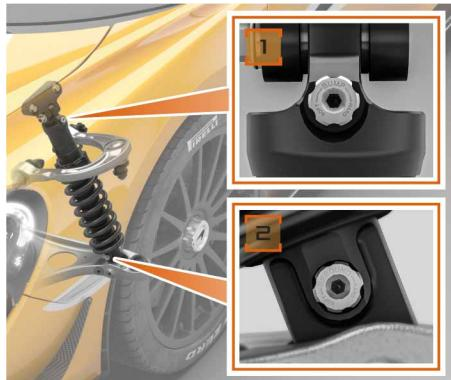
Il dispositivo di regolazione del ritorno si trova alla base del corpo dell'ammortizzatore e presenta 35 posizioni diverse. La rotella di regolazione deve essere girata in senso orario per irrigidire gli ammortizzatori e in senso antiorario per allentarli.
