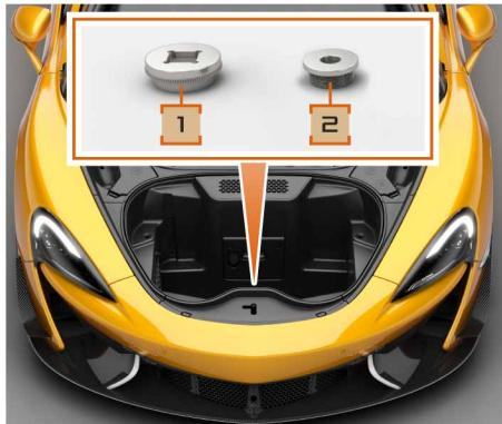
Gli attrezzi per la rimozione dell'anello di bloccaggio centrale del dado della ruota (2) e per il serraggio dei dadi (1) si trovano nella parte anteriore del vano del bagagliaio.
