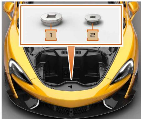
As ferramentas de remoção do anel de fixação central das porcas da roda (2) e de binário das porcas (1) encontram-se no porta-bagagens dianteiro.
