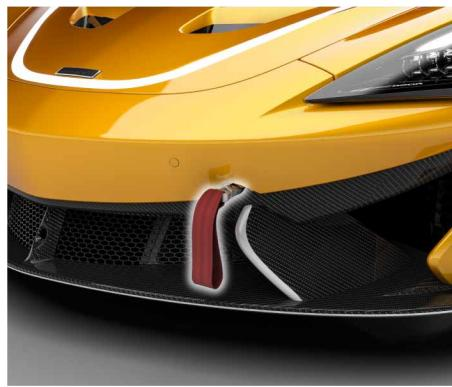
O seu McLaren está equipado com uma correia de reboque dianteira para utilização em pista.
