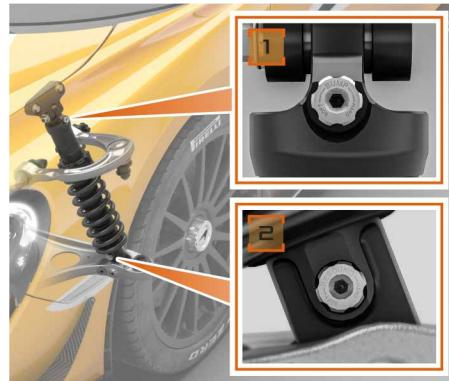
El regulador de rebote está situado en la base del cuerpo del amortiguador. El ajuste de rebote tiene 35 posiciones diferentes. La rueda de ajuste debe girarse en el sentido de las agujas del reloj para endurecer y en el sentido contrario para suavizar.
