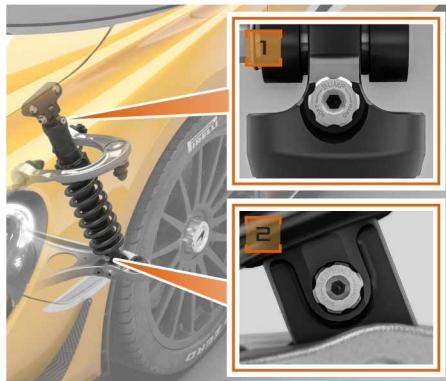
O ajustador de descompressão está localizado na base do corpo do amortecedor. O ajuste de descompressão tem 35 posições diferentes. A roda de ajuste deve ser girada no sentido horário para aumentar a rigidez e no sentido anti-horário para suavizá-la.
