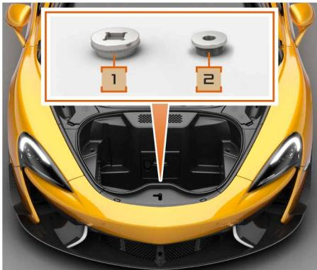
As ferramentas de remoção do anel de travamento central da porca da roda (2) e da porca da roda (1) estão localizadas no porta-malas dianteiro.
