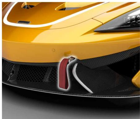
Seu veículo McLaren está equipado com uma cinta de reboque dianteira, para uso em autódromo.
