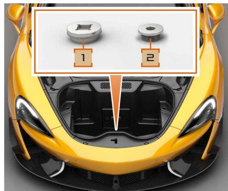
La herramienta de retiro del anillo de fijación del centro de la tuerca de la rueda (2) y la herramienta de par de la rueda (1) se ubican en el maletero delantero.
