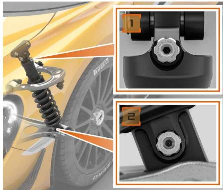
El ajustador de rechazo se ubica en la base de la caja del amortiguador y se puede ajustar en 35 posiciones diferentes. La rueda de ajuste se debe girar a la derecha para apretar y a la izquierda para aflojar.
