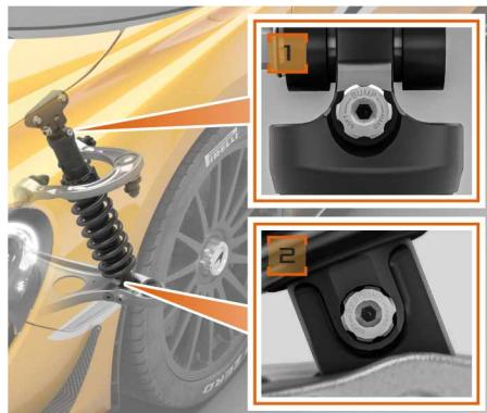
反彈調整器位於避震器本體底部，反彈調整有35個不同的位置。調整輪若要調硬應以順時針旋轉，若要調軟則應以逆時針旋轉。
