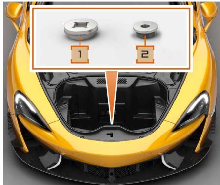
車輪螺帽中心鎖環拆卸(2)和螺帽扭矩(1)工具位
