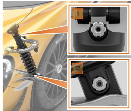
Le dispositif de réglage du ressort est situé au bas du corps de l'amortisseur. Le réglage du ressort comporte 35 positions. Tournez la roue de réglage dans le sens horaire pour raidir l'amortisseur et dans le sens antihoraire pour l'assouplir.
