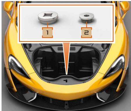
Les outils de retrait de l'anneau central de verrouillage des écrous de roue (2) et de serrage des écrous (1) sont logés à l'avant du compartiment à bagages.
