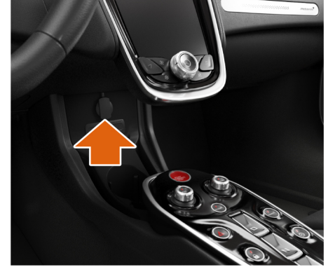
مقيس طاقة الملحقات الداخلي بجهد 12 فولت
